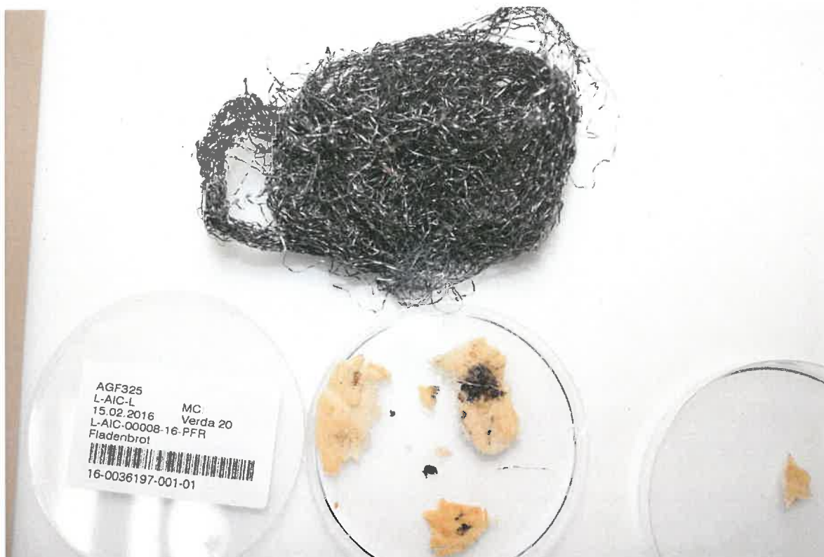
Foto 20: Übersicht: mit vorgelegte Stahlwolle (oben) sowie Probenisolate mit beiliegendem einzelnen Faden der Stahlwolle (Petrischale unten)
