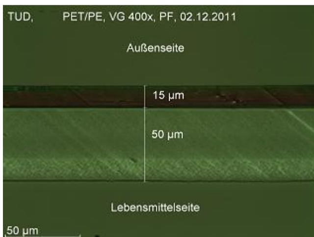
Polyethylenterephthalat / Polyethylen metallisiert
